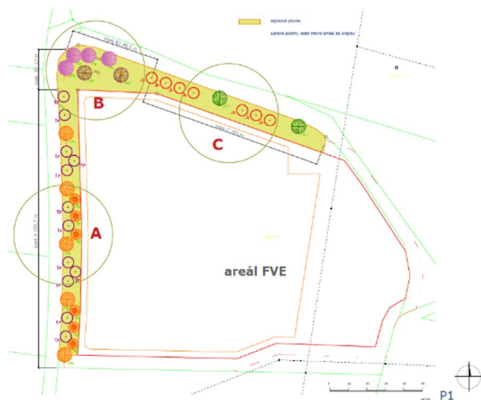
Příklad izolační zeleně, která zajišťuje opticky přívětivé zasazení FVE do krajiny.
